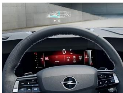
Intelli-HUD (Head up Display) premieta dôležité informácie na čelné sklo
